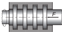
Perno di spinta ad anelli multipli.
