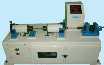
Figura 9 Macchina di Moore per la prova a fatica a flessione rotante.
