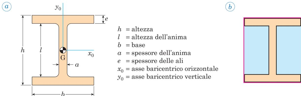
Fig. 3.17 - a) Sezione a doppia T trattata nell'Esempio 3.8.
