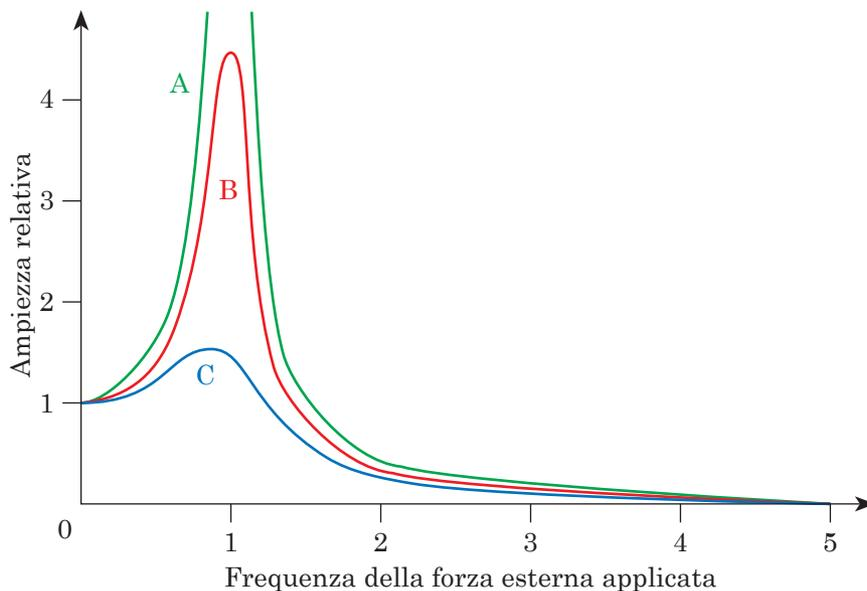
Fig. 8.17 - Ampiezza delle vibrazioni in funzione della frequenza della forza esterna applicata espressa come multiplo della frequenza naturale del sistema: 1 è la frequenza naturale del sistema. La curva A è la curva teorica di risonanza in assenza completa di smorzamento, mentre le curve B e C corrispondono a due condizioni di smorzamento: più debole per B e più elevato per C.
