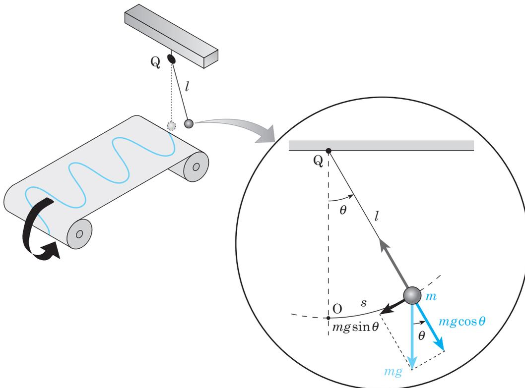
Fig. 8.15 - Un pendolo semplice, sospeso al perno  $Q$ , ha la massa  $m$  che oscilla avanti e indietro passando ogni volta per  $O$ . Se l'angolo  $\theta$  è piccolo, l'oscillazione può essere considerata quella di un moto armonico semplice.
