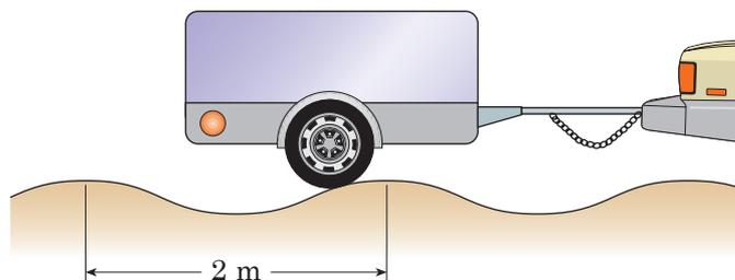
Fig. 8.19 - Risonanza sulle molle di un carrello dell'Esempio 8.8.
