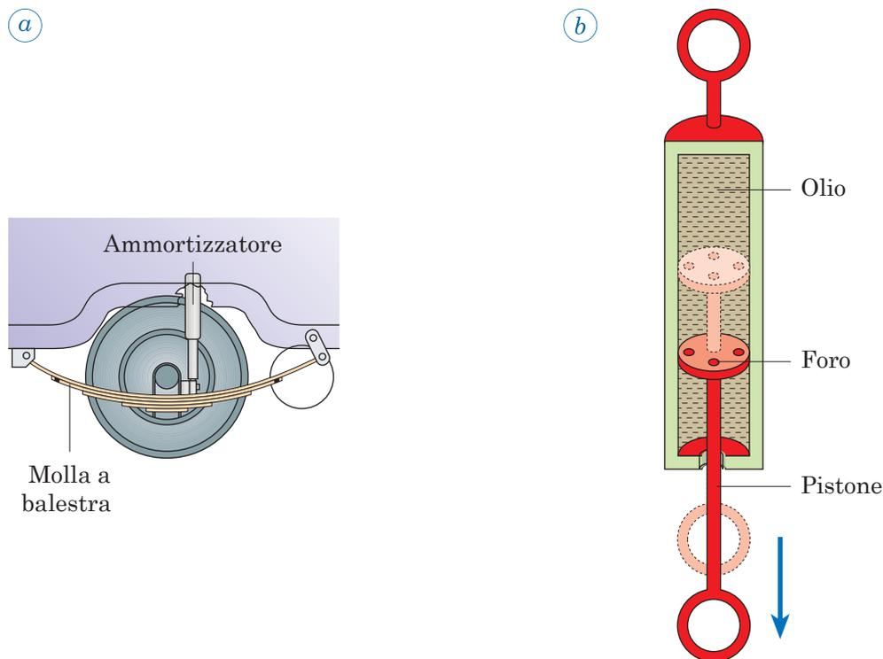
Fig. 8.18 - Schema semplificato di un ammortizzatore di una vettura. Il pistone è situato in un serbatoio pieno d'olio; allorché il pistone si muove reagendo a una gobba della strada, l'olio che passa attraverso i fori genera delle forze viscose che smorzano le oscillazioni.
