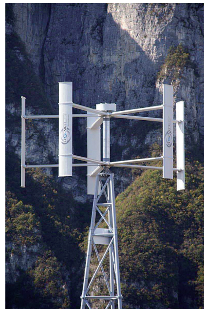
Fig. 11.17 - Aerogeneratore ad asse verticale (ROPATEC) usato in zone climaticamente severe, come quelle montuose o artiche. Sono infatti aerogeneratori più semplici per l'assenza del sistema che regola l'inclinazione della gondola rispetto alla direzione del vento.
