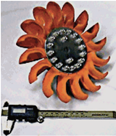
Fig. 18.19 - Microturbina Turgo (WKV). Le turbine Turgo, a uno oppure a due getti, possono arrivare fino alla potenza di 5000 kW.
