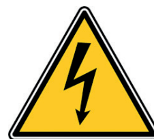
Fig. 25 - Simbolo di pericolo di tipo elettrico.
