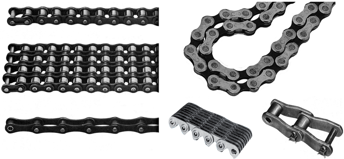
Fig. 26.19 - Alcuni tipi di catene a rulli e una catena a piastrene per ingranamento silenzioso. In quest'ultime le piastre sono sagomate in modo da appoggiare contro i denti del rocchetto permettendo un recupero automatico di eventuali giochi e un funzionamento cinematicamente corretto.
