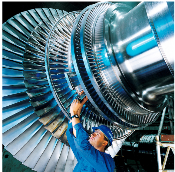
Fig. 35.16-b - Rotore di una turbina a vapore usata in un impianto termoelettrico. L'altezza delle palette aumenta progressivamente passando dall'ingresso all'uscita a causa dell'aumento del volume massico del fluido durante l'espansione.
