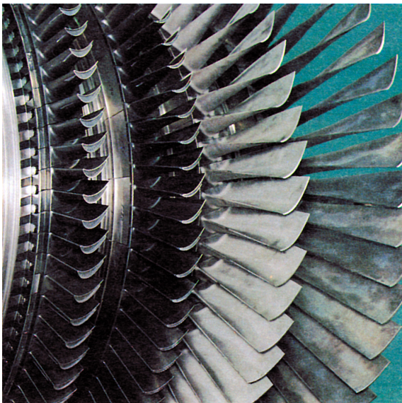
Fig. 35.16-a - Palette vistosamente svergolte (le più alte su sfondo verde) nel quarto stadio di una turbina a gas.
