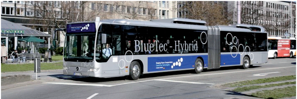
Fig. 43.11-b - Autobus ibrido Citaro a Stoccarda (2009): ibrido-serie, 4 motori elettrici sui mozzi delle ruote degli assi medio e posteriore, potenza elettrica 320 kW, motore a combustione interna Daimler con cilindrata di 4,8 litri notevolmente ridotta rispetto a quella del motore termico originale per autobus che aveva una cilindrata di 12 litri.
