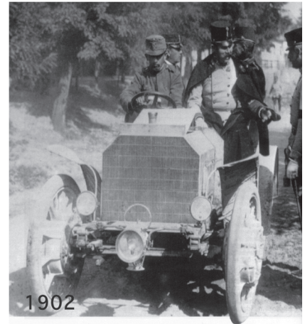
Fig. 43.11-a - Vettura Lohner-Porsche Mixte (1902); ibrido-serie sviluppato da Ferdinand Porsche: 4 motori elettrici sui mozzi delle ruote, 1 motore a combustione interna Daimler, batterie al piombo.
