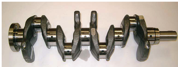
Fig. 48.42 - Albero a gomiti del motore della Toyota Yaris 1.4 TDI con 4 contrappesi di equilibratura e flangia per attacco al volano.
