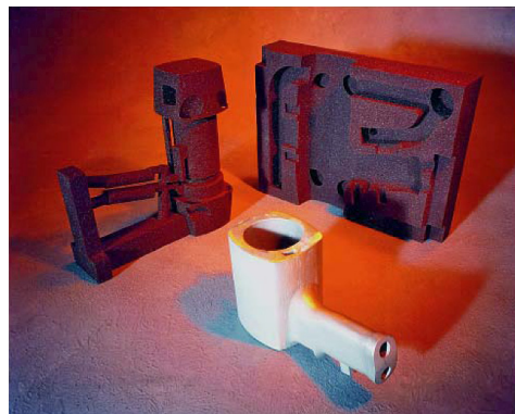
Fig. C.2.6 - Sinterizzazione delle polveri (SLS) – Sintering di sabbia.
