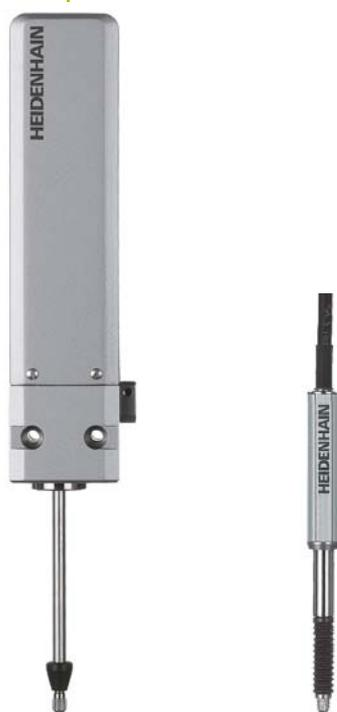
Nei **sistemi di misura lineari incrementali** la posizione attuale viene determinata, partendo da un'origine definita, mediante conteggio di passi di misura o mediante suddivisione e conteggio di periodi del segnale. Per riprodurre l'origine, i sistemi di misura incrementali di HEIDENHAIN sono dotati di indici di riferimento da superare dopo l'accensione. Questa procedura risulta particolarmente semplice e veloce se si impiegano indici di riferimento a distanza codificata.
