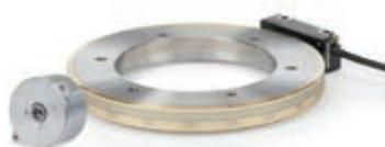
Nei **sistemi di misura angolari e trasduttori rotativi incrementali** la posizione attuale viene determinata, partendo da un'origine definita, mediante conteggio di passi di misura o mediante suddivisione e conteggio di periodi del segnale. Per riprodurre l'origine, i sistemi di misura incrementali di HEIDENHAIN sono dotati di indici di riferimento.
