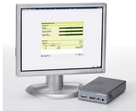
Tester PWM 20 con il software di taratura e diagnostica ATS incluso nello standard di fornitura
