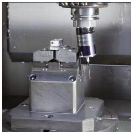
Sistema di tastatura con **trasmissione del segnale via radio o a infrarossi** per macchine con cambio utensili automatico:
