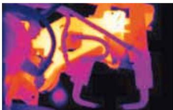
*Punto caldo su robot di saldatura*
