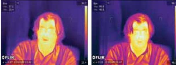
*L'immagine termica sulla sinistra ha la corretta impostazione di emissività per la pelle umana (0,97) e la lettura della temperatura è corretta (36,7 °C). Per l'immagine termica sulla destra è stata inserita un'emissività sbagliata(0,15), che ha generato la falsa lettura della temperatura (98,3 °C).*
