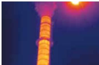
*Ispezione del materiale refrattario nel camino di una camera di combustione.*
