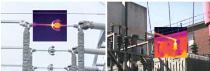
*La funzione Picture-in-Picture permette di avere una panoramica precisa delle installazioni ad alta tensione.*
