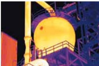
*Ispezione dell'isolamento refrattario in un reattore petrolchimico.*
