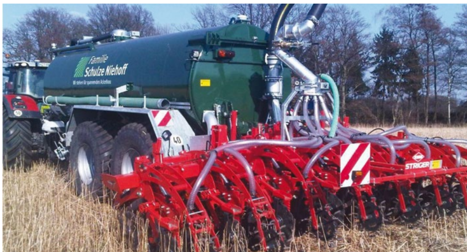
Foto 3 - Da un'azienda agricola tedesca: un altro cantiere per strip till con interrimento dei liquami.
