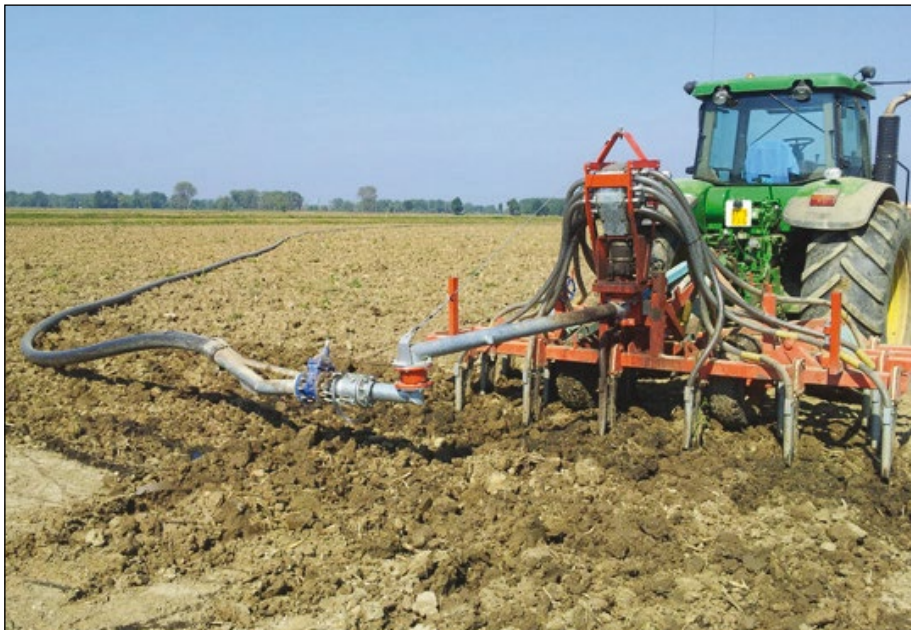
Figura 5 – Sistema di distribuzione ombelicale Acquafer (fonte: www.acquaferagri.it ).
