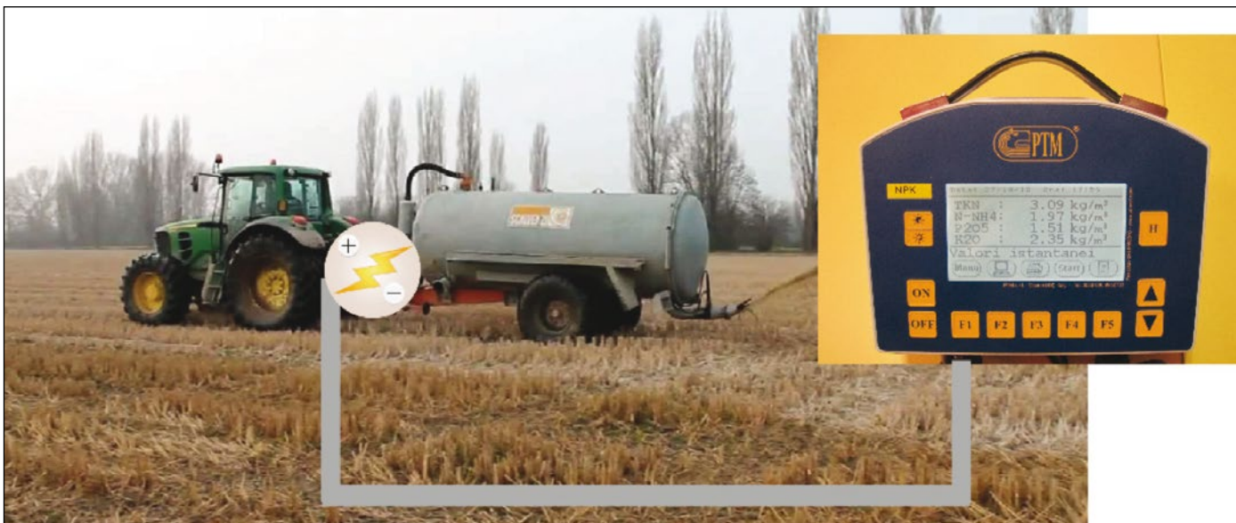
Le possibilità di alimentazione del dispositivo sono due: alimentazione fornita da cavo collegato direttamente al trattore, alimentazione fornita da batteria ricaricabile (in dotazione del dispositivo). (Gaggi, 2015)
