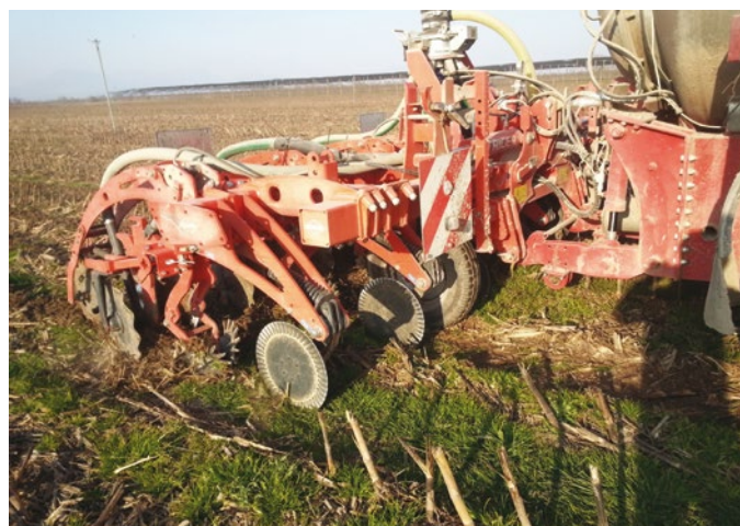
Foto 2 - Ancora l'operazione di strip till. In evidenza la botte dei liquami, il rotore che distribuisce i liquami ai vari tubi di scarico, gli stessi tubi che raggiungono il livello del suolo per l'interramento dei liquami.
