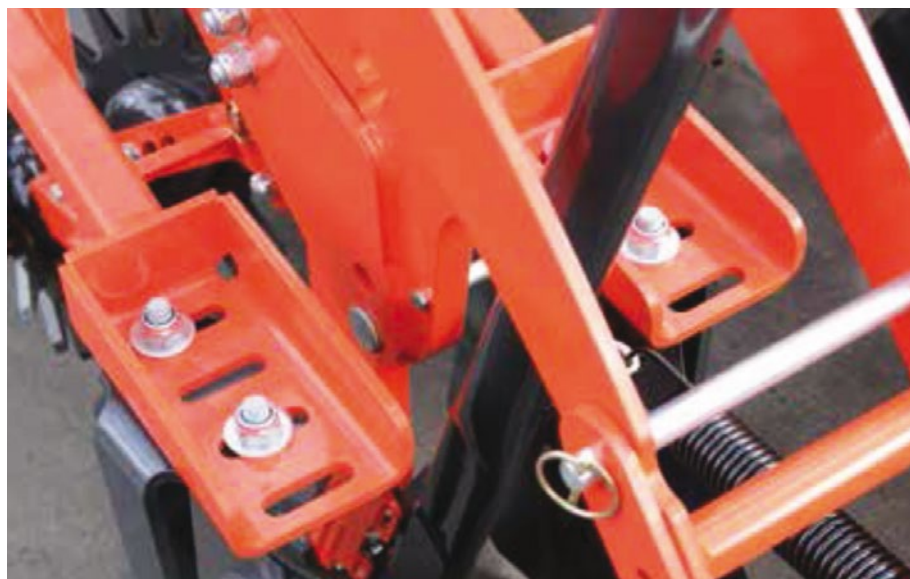
Foto 8 - Posizionato dietro l'ancora c'è il tubo per l'interrimento dei reflui, dal diametro di 50 mm.
