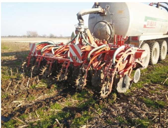
Foto 5 e 6 - Dall'azienda di Mirco Zecchini (Pordenone): l'applicazione dello strip till con interrimento dei liquami.
