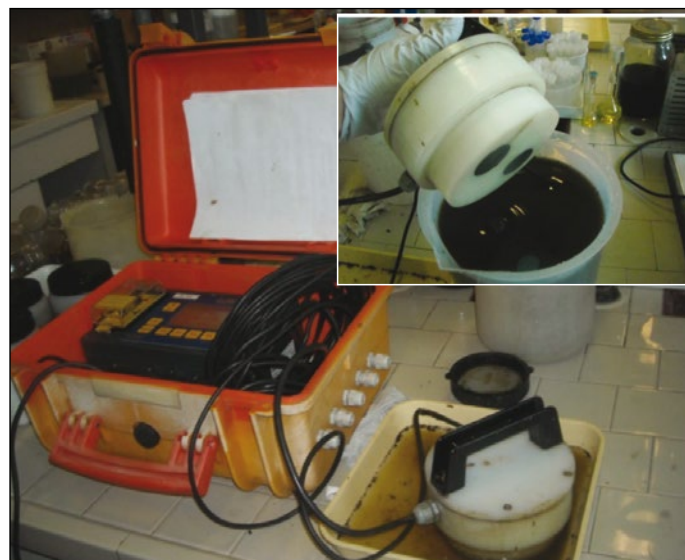
A sinistra: la sonda è collegata direttamente al carro-botte. A destra: la sonda è posta dentro contenitori di diverse misure contenenti liquame. (Gaggi, 2015)
