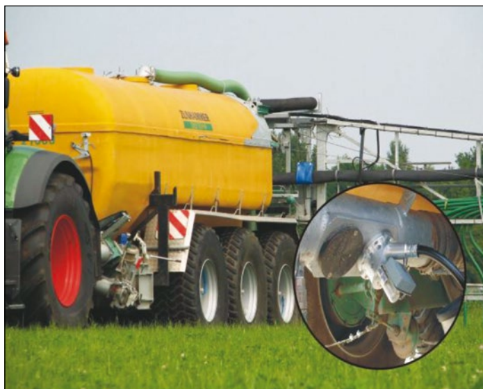
A sinistra: la sonda è collegata direttamente al carro-botte. A destra: la sonda è posta dentro contenitori di diverse misure contenenti liquame. (Gaggi, 2015)
