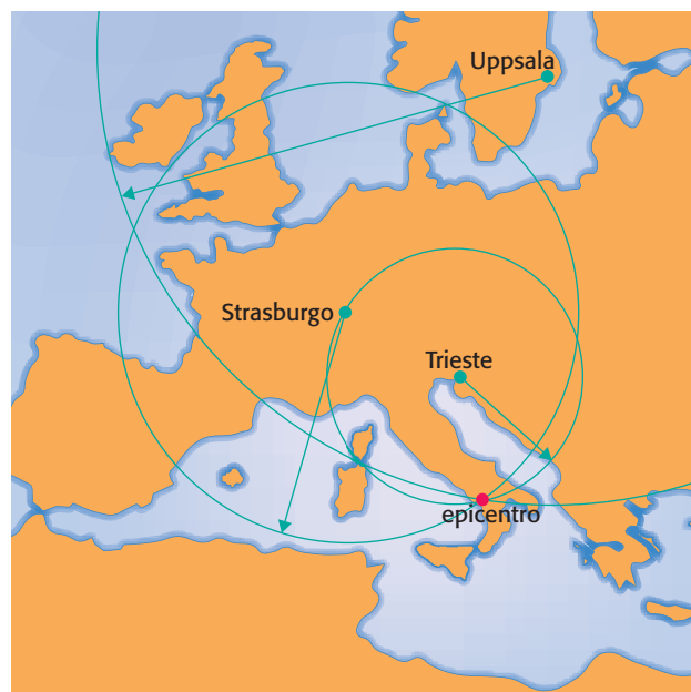
Figura 2 Per localizzare l'epicentro è necessario conoscerne la distanza da almeno tre stazioni sismiche. Si tracciano su una carta geografica le tre circonferenze che hanno come centro le località in cui si trovano i sismografi; le tre curve si incroceranno tra loro in un solo punto che individua l'epicentro del terremoto.
