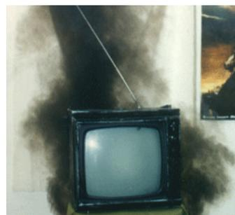
Numerosa è la casistica di anomalie riguardante gli impianti elettrici, i quali possono causare principi d'incendio dovuti a: corti circuiti, conduttori flessibili danneggiati, contatti lenti, surriscaldamenti dei cavi o dei motori, guaine discontinue, mancanza di protezioni, sottodimensionamento degli impianti, apparecchiature di regolazione mal funzionanti ecc.
