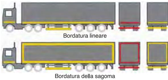
Nastro conforme al regolamento ECE ONU 104 omologato
