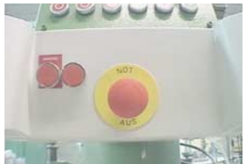
Fig. 57: Dispositivo di comando che fornisce un’informazione immediata.
