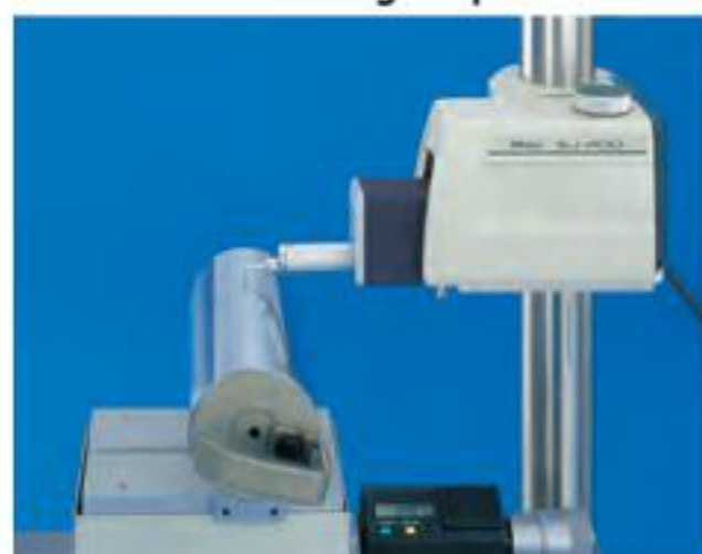
Misura rugosità superficiale
