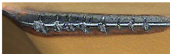
Microfessurazioni termiche dovute al fluido da taglio
