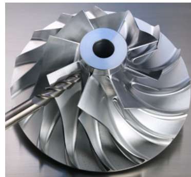
La lavorazione di giranti/blisk è un esempio applicativo di fresatura di angoli chiusi.
