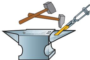
La lavorazione viene eseguita a mano o a macchina per mezzo di appropriati attrezzi (martelli o mazze) che deformano, per percussione o per pressione, i materiali portati a elevata temperatura (**Fig. 167**).
